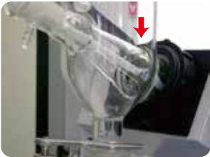
專利防冷凝液回流設計 (專利號7209346)
